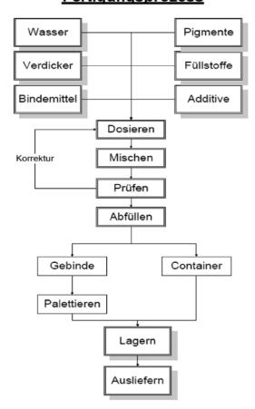
Die Abbildung verdeutlicht folgende Arbeitsschritte bei der Herstellung der Fassadenfarben: Zunächst werden die Silos und Wägebehälter befüllt. Anschließend erfolgt die Förderung und Dosierung der Rohmaterialien in den Mischer zur Dispergierung. Nach der Prüfung der Qualitätskontrolle werden die Fassadenfarben in Gebinde und Container abgefüllt, verladen und ausgeliefert
